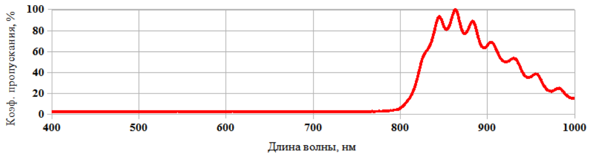
Рис. 3. Спектр излучения опорного источника, прошедшего через НWB830
