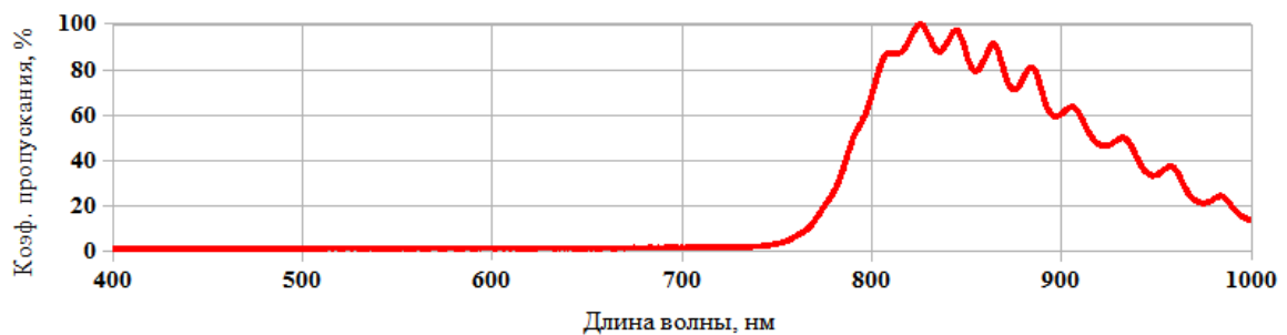
Рис. 2. Спектр излучения опорного источника, прошедшего через НWB780
