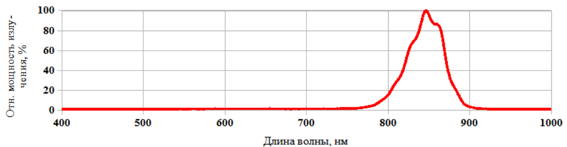
Рис. 4. Спектр излучения светодиодного кольца
